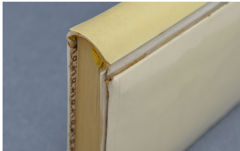
Obr. 40 Barevná změna knižních desek způsobená vlivem světla
