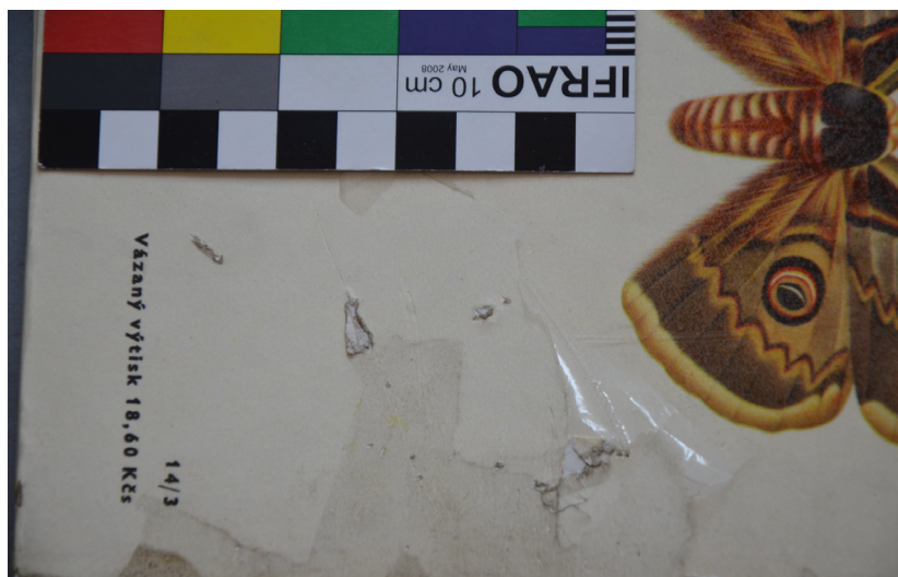
Obr. 38 Odlepování laminační fólie
