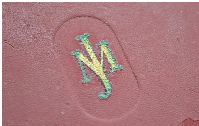
Obr. 51 Vznik výkvětů a měděnky na ražbě s mosaznou fólií
