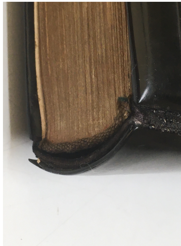
Obr. 20 Prasklá hrana hřbetní části pokryvu (u paty) před (vlevo) a po restaurování (vpravo)
