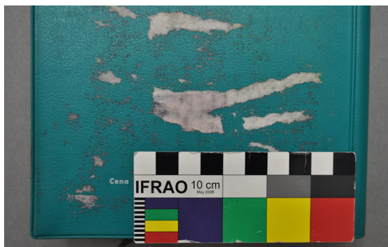
Obr. 44 Exemplář obsahující zbytky adheziva a papíru (zadní strana desky)
