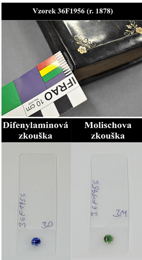
Obr. 11 Důkaz nitrátu celulózy pomocí kapkových zkoušek
