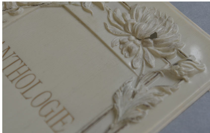
Obr. 42 Ztráta materiálu destičky z CN zdobící knihu
