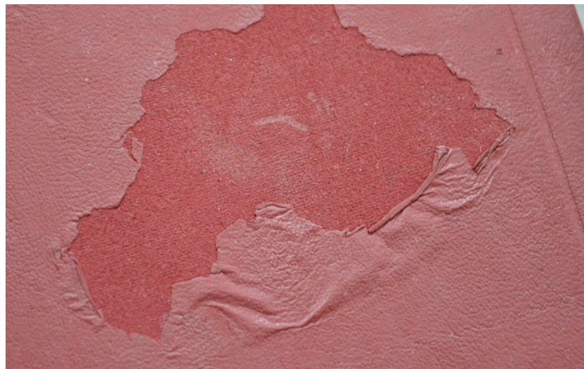
Obr. 50 Lepkavý povrch a odlepení potahu na plastové desce
