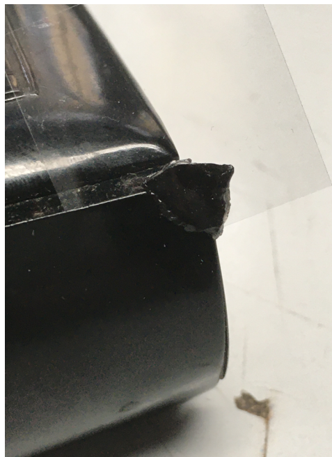
Obr. 16 Záplata přiložená na místo ztrát
