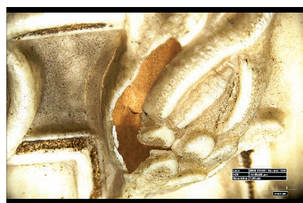
Snímek poškození reliéfu knižní desky z nitrátu celulózy. Foto: Jitka Neoralová
