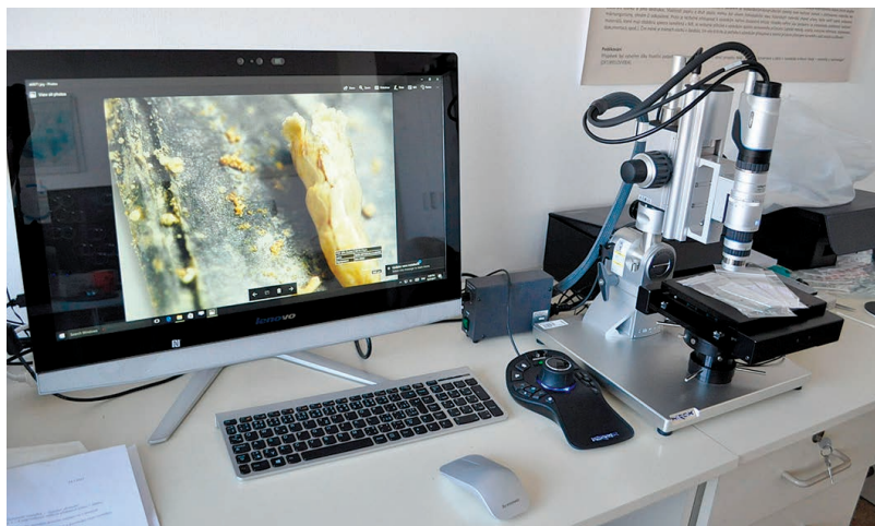
3D mikroskop Hirox – na obrazovce výkvět na olověném kupónu z Oddyho testu. Foto: Jitka Neoralová
